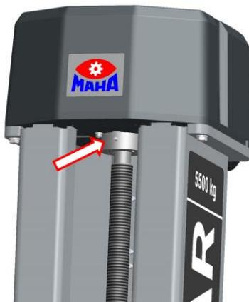
Lubrifier au moins une fois par an le roulement de broche sur la partie supérieure. Pour cela, amener le chariot de levage dans la position la plus basse, desserrer le capot de la broche sur la plaque supérieure et le retirer. Puis lubrifier le roulement de broche à l'aide du graisseur avec de la graisse multi-usage. Points à lubrifier, voir section « Maintenance > Lubrification > Points à lubrifier et lubrifiants ».
