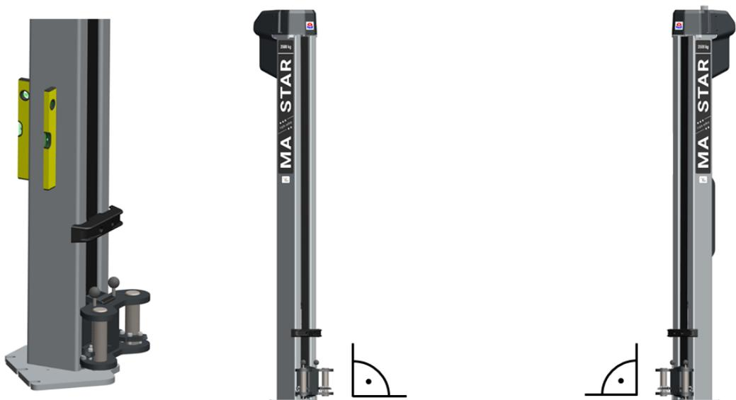
Si les colonnes de levage ne sont pas verticales et/ou ne reposent pas correctement sur le sol, la plaque d'appui doit être étayée en conséquence.
