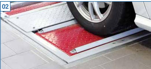
Der Achsdämpfungsprüfstand MSD 3000 zeichnet sich durch eine schnelle und präzise physikalische Überprüfung der Achsdämpfung aus (Lehr'sches Prinzip). Der vollautomatische Prüfablauf inkl. Ermittlung von Achs- und Fahrzeuggewicht ermöglicht dabei eine zeitsparende und sichere Beurteilung der Achsdämpfung.
