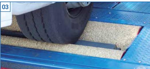
Der prüfstraßenfähige Rollen-Bremsprüfstand MBT 7000 dient zur Bremsprüfung von Fahrzeugen bis zu einer Achslast von 18,0 t und eignet sich ideal zur Diagnose bei sehr hohem Fahrzeugdurchsatz.
