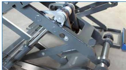
Wartungsfreie Zylinder-Aushubunterstützung: Volle Hubkraft bereits im unteren Hubhöhenbereich. Sanftes An- und Abfahren mit verzögerter Geschwindigkeit.
