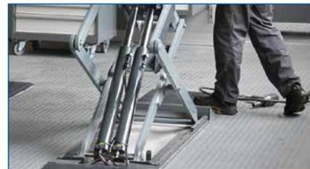
Doppelte Sicherheit durch zwei Hubzylinder je Scherenseite, vollhydraulisches System; keine Sicherheitsklinke und keine Druckluft für den Betrieb erforderlich.
