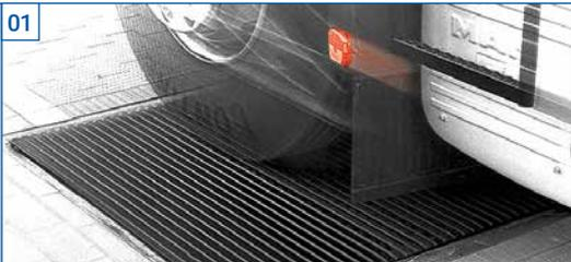
Der prüfstraßenfähige MINC II EURO garantiert eine sekundenschnelle Überprüfung der Achsgeometrie bei Überfahrt des Prüffahrzeugs (bis 15,0 t Achslast) sowie eine vollautomatische Befundauswertung der Abweichung in m/km.
